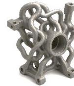
Possibilité de réaliser des géométries complexes, impossibles à obtenir par méthodes traditionnelles (problème de dépouille ou de plan de joint).
