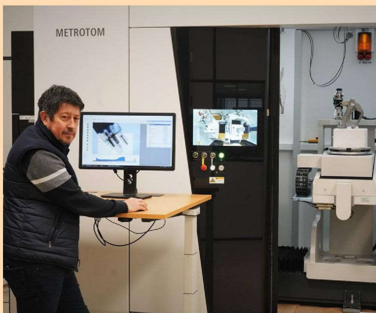
Le tomographe permet des inspections non destructives des pièces. J.B
